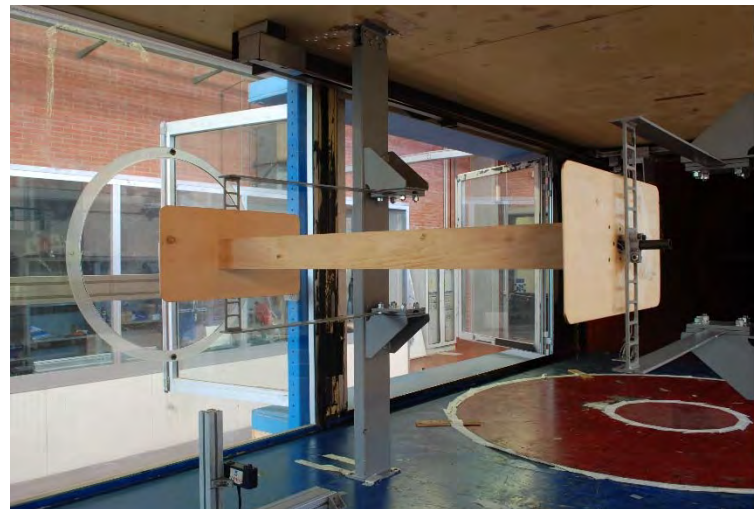
Vibrazioni aeroelastiche di prismi rettangolari allungati
